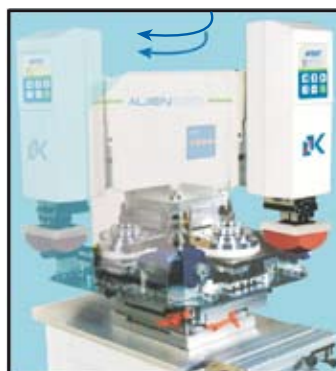
Rotation à 90° pour un changement de tampon / cliché facilité
