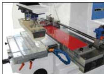
Side way (encrier latéral) pour l'impression d'images longues (SCMIC)
